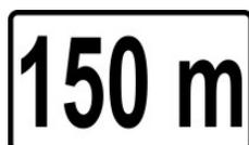
An Bahnsteigen ohne eine Haltetafel (Signal Ne 5) können Orientierungszeichen „Zuglänge“ aufgestellt sein. Sie kennzeichnen den verkehrlich günstigsten Halteplatz des Zuges.
