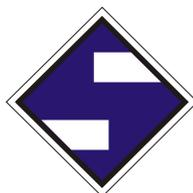
(3) Das Signal kündigt ein „Bügel ab“-Signal (EI 4) an.
