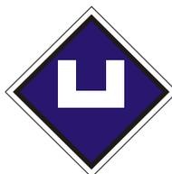
(3) Nach der Vorbeifahrt am Signal darf das Triebfahrzeug eingeschaltet werden. \*
