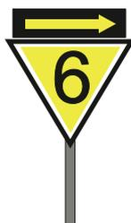
Bei einem rückstrahlenden Signal ist auch der Richtungspfeil rückstrahlend.
