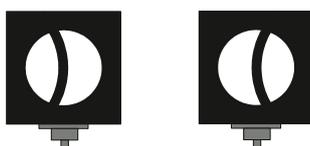
(7) Bei Fahrten aus dem linksseitigen Gleis ist die Sichel nach links, bei Fahrten aus dem rechtsseitigen Gleis ist die Sichel nach rechts geöffnet.
