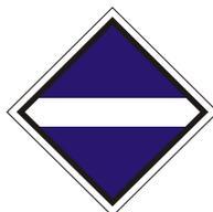
(3) Das Signal kennzeichnet den Beginn eines Gleisabschnitts, der nur mit gesenkten Stromabnehmern befahren werden darf.
