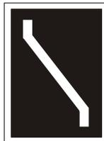
(3) Der Gegengleisanzeiger zeigt an, dass auf zweigleisiger Strecke das Gleis entgegen der gewöhnlichen Fahrtrichtung befahren werden darf. Der Auftrag, das Gleis entgegen der gewöhnlichen Fahrtrichtung zu befahren, gilt bis zum nächsten Bahnhof. Liegt davor eine Abzweig- oder Überleitstelle, gilt der Auftrag bis dahin. **Geltung**
