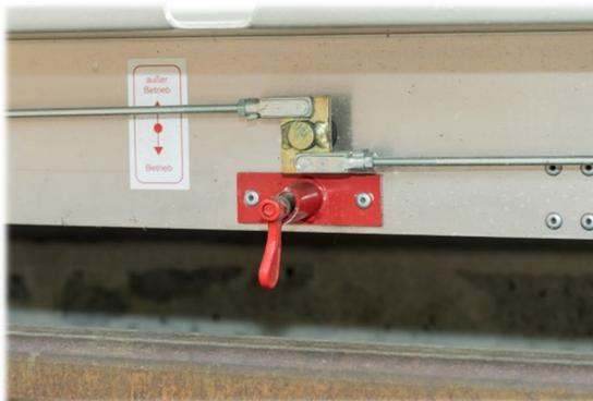
Abbildung 20: Ausschalen der Bremse
