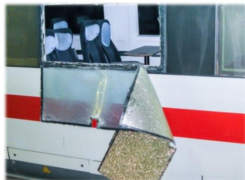
Abbildung 19: Notausstiegsfenster lassen sich nach außen wegdrücken
