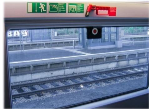
Abbildung 18: beispielhafte Kennzeichnung Notausstiegsfenster
